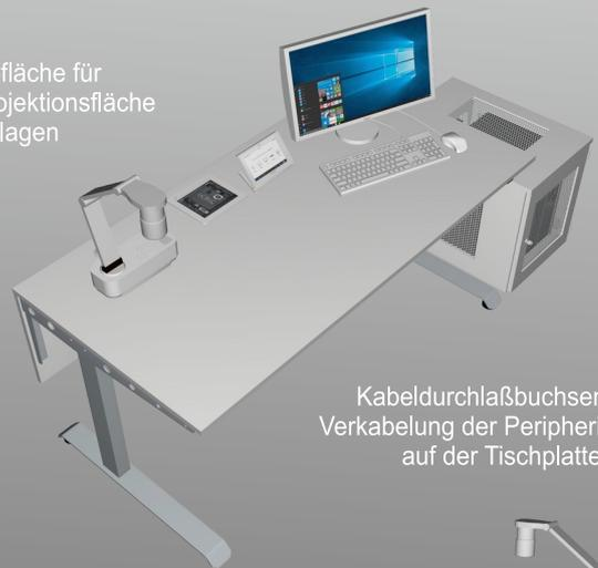
Kabeldurchlaßbuchsen zur Verkabelung der Peripheriegeräte auf der Tischplatte
